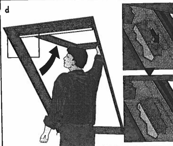
**ESPAÑOL:** Conexión de los muelles a los herrajes: Cierre la ventana utilizando la barra de maniobra (a, b). Luego abra la ventana utilizando la manilla de la parte inferior de la hoja (c). Empuje la hoja hacia fuera, asegurándose de que los herrajes y los muelles de ambos lados se conectan automáticamente (d).
